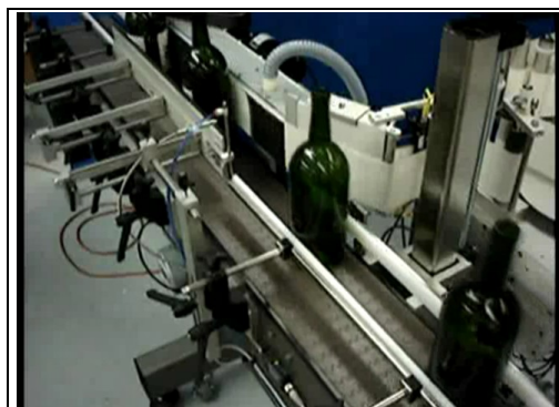
Контрэтикетка удерживается вакуумным ремнем станции прокрутки и наносится на бутылку по мере ее продвижения по конвейеру.
