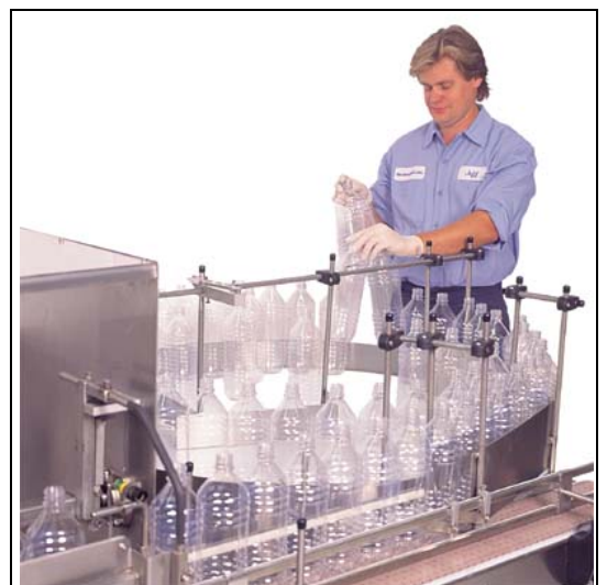
Направляющие ротационного стола подачи бутылок предотвращают их падение
