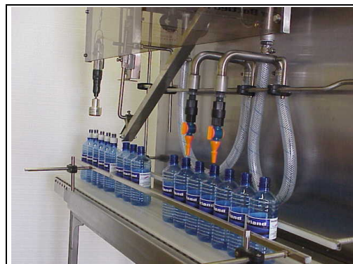
Установка адаптера позволяет использовать модель NORLAND BF для разлива воды в небольшие бутылки и их укупорки.
