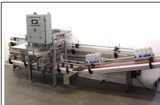
Автоматическая установка NORLAND CasePak позволяет сократить ручной труд для укладки готовой продукции на поддоны или в коробки.
